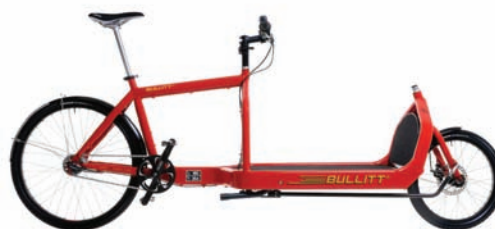
図 2: 縦方向に長い荷台を持つ自転車 (出典: Larry vs Harry) ののは難しいと考えられる。普通自転車と同様に扱えて荷物を積める、我が国の実状に合わせた自転車デザインが実現すれば好ましいといえる。
